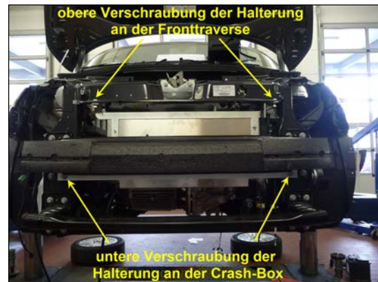
Bild 12: Befestigungspunkte der Ladegeräteinheit
