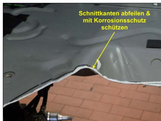
Bild 14: Schnittkanten entgraten & schützen
