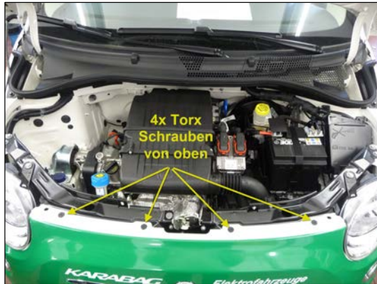
Bild 1: Demontage der Stoßstange
