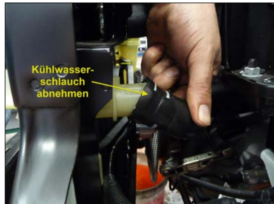
Bild 24: obere Kühlwasserschlauch abziehen
