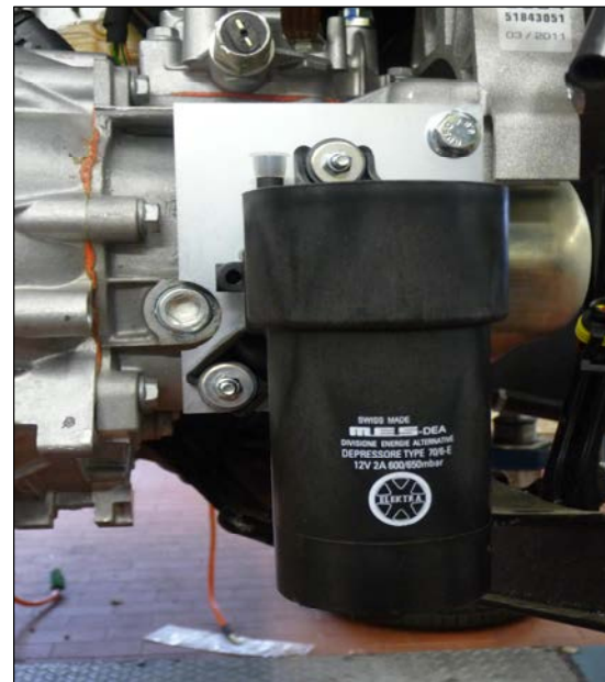
Bild 6: Ausrichtung der Montageplatte beachten
