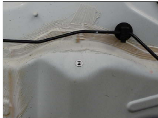
Bild 6: Steg an der Spritzwand
