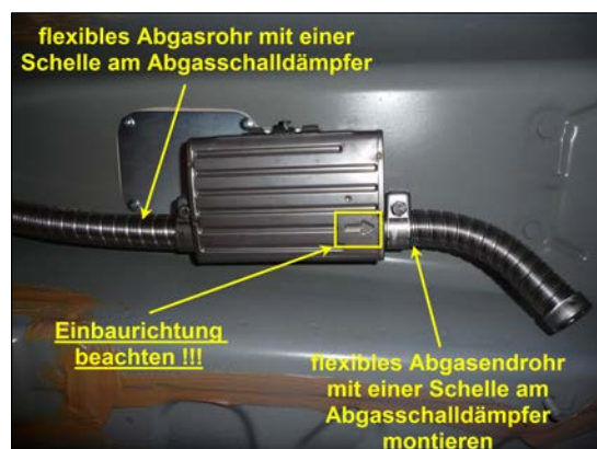
Bild 12: Montage Abgasrohr & Abgasendrohr
