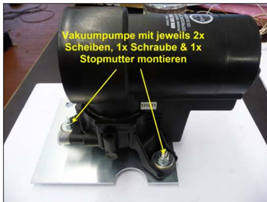
Bild 3: Vakuumpumpe montieren
