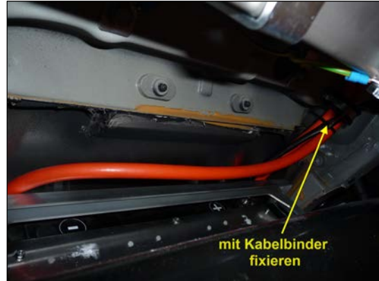
Bild 20: Kabel mit Kabelbinder fixieren
