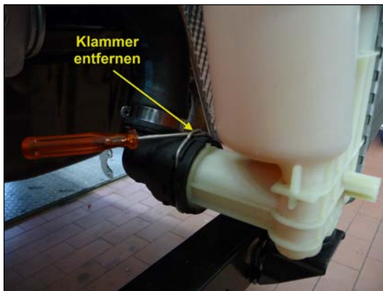
Bild 21: Demontage des Kühlwasserschlauchs
