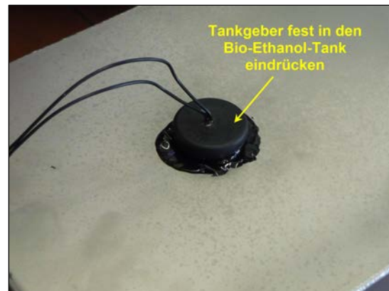
Bild 4: Tankgeber in den Tank fest eindrücke
