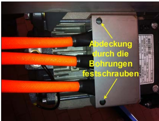
Bild 21: Abdeckung für Motoranschlüsse fixieren
