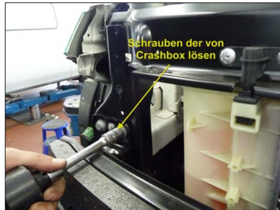
Bild 16: Demontage der Crashbox
