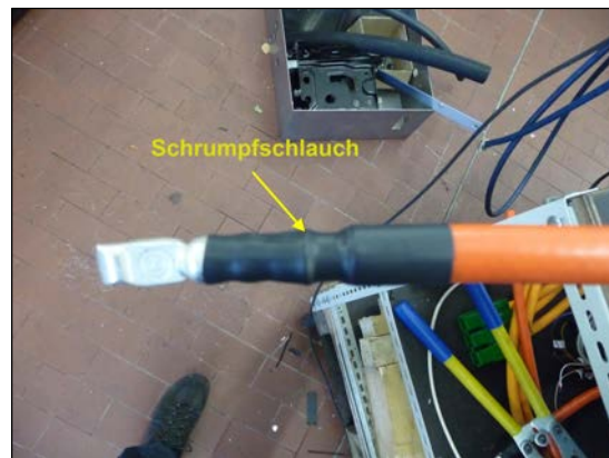
Bild 18: HV- Kabel mit Schrumpfschlauch
