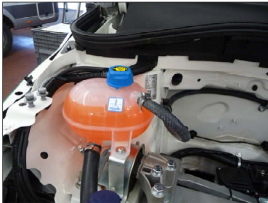
Bild 21: Wasserkreislauf befüllen &amp; entlüften
