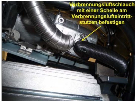
Bild 13: Montage Verbrennungsluftschlauch
