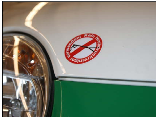
Bild 10: Warnhinweis auf der Motorhaube
