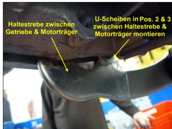
Bild 6: Position Haltestrebe
