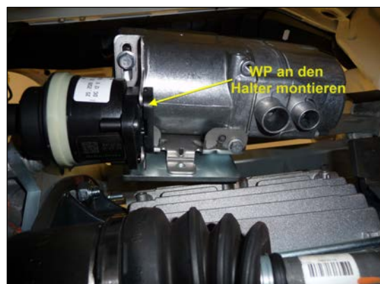
Bild 6: Wasserpumpe montieren
