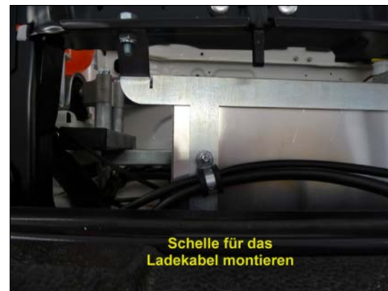
Bild 20: Schelle für das Ladekabel montieren
