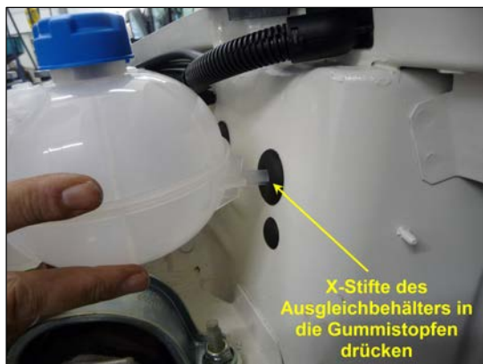
Bild 3: X-Stifte in die Gummistopfen drücken
