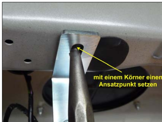
Bild 7: Bohrstelle kornen
