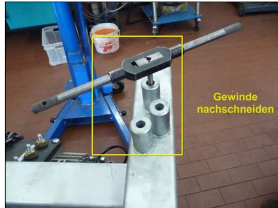
Bild 2: alle drei Gewinde nachschneiden M10x1,5
