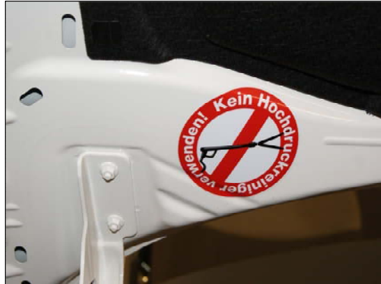
Bild 8: Warnhinweis unter der Motorhaube
