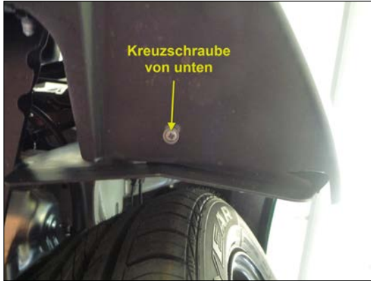
Bild 5: Kreuzschrauben von unten
