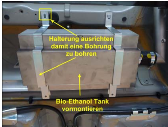
Bild 5: Tankhalter ausrichten
