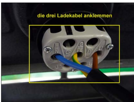
Bild 3: Adern des Ladekabels anklemmen
