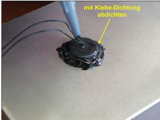
Bild 5: Tankgeber mit Klebe-Dichtung abdichten
